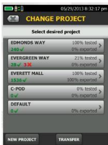
Ekran Menu projektu przedstawia procentowy stan ukończenia zadania
