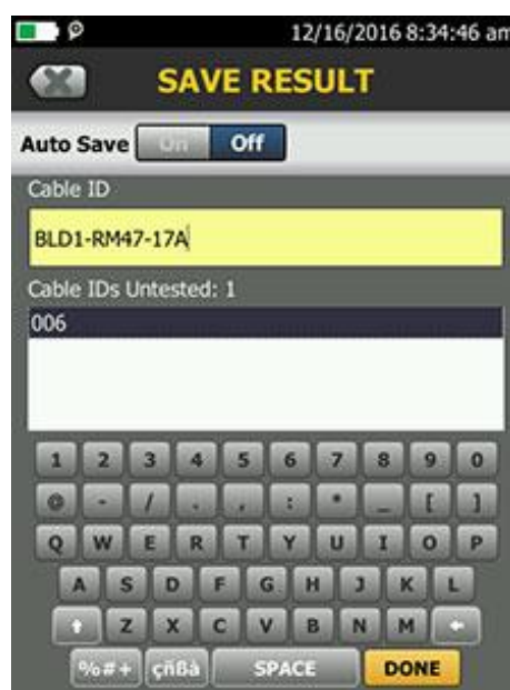
Szybkie wprowadzanie ID kabli za pomocą ekranu pojemnościowego
